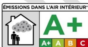
Les panneaux de liège expansé QualyCork ont été testés selon la norme ISO 16000-9. L'objet de ce test est de mesurer l'émission des différents VOC (volatile organic compounds) dans le climat intérieur.
